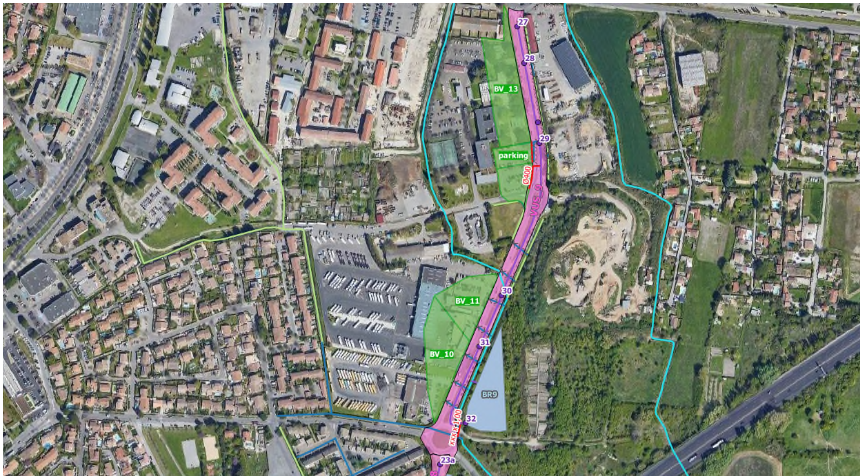
Figure 16 : Synoptique de l'assainissement pluvial projeté (3/3)
